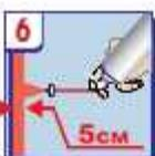
При напылении курок нажимать до упора. Толщина напыленного слоя увеличивается на 20% через 20 мин, поэтому напылять не более 4 см (4 см + 20% = 5 см). При необходимости большей толщины, наносить следующий слой через 20 мин после нанесения первого. Перед этим следует убедиться, что нет капель воды на предыдущем слое. Количество слоев не ограничено.
