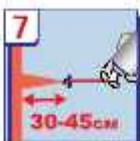
Напыление производят на расстоянии от 30 до 45 см от поверхности в зависимости от формирования факела. Чем больше расстояние - тем шире поверхность напыления.
